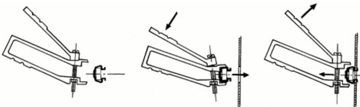
Diese Zange ermöglicht ein schnelles und genaues Einsetzen der Käfigmutter in Stanzlöcher 8,3 x 8,3 und 9,5 x 9,5 mm.
